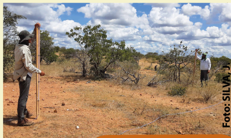
Foto 20: Marcação de curva de nível por meio do nível de mangueira, Curaçá-BA.
